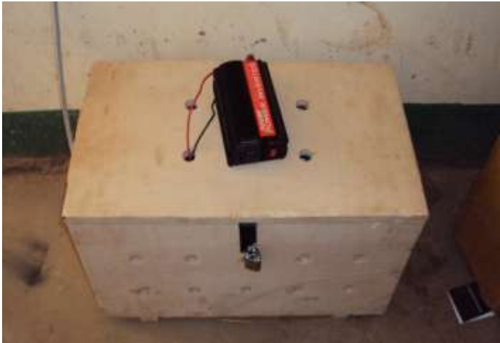
Coffret de batterie et convertisseur 300W pour recharge des portables - 1 er dortoir
