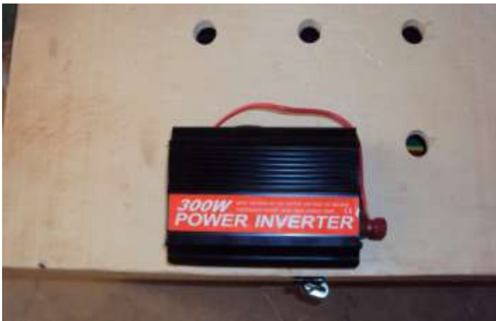
Coffret de batterie et convertisseur 300W pour recharge des portables - 1 er dortoir
